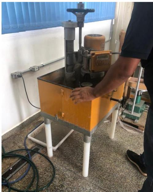
Figura 24 – Preparo do corpo de prova para ensaio de compressão.
