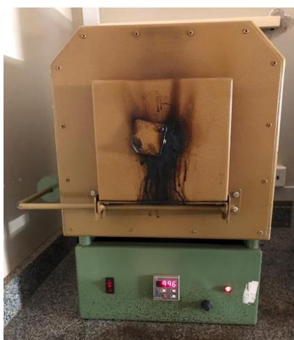
Figura 14 – Mufla utilizada no ensaio de 1000 °C.
