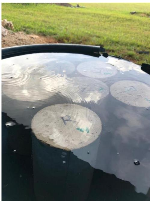
Figura 26 – Corpo de prova imerso em água por 72 horas.
