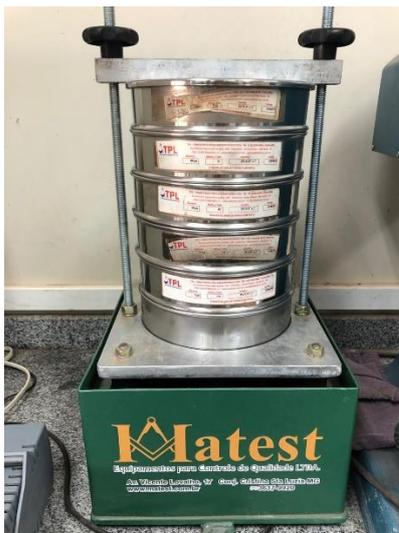
Figura 12 – Cinza do bagaço da cana de açúcar sendo ensaiada conforme NBR NM 248/2003.
