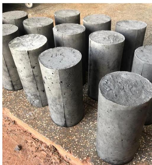
Figura 21 – Corpos de prova desenformados após 24 horas.
