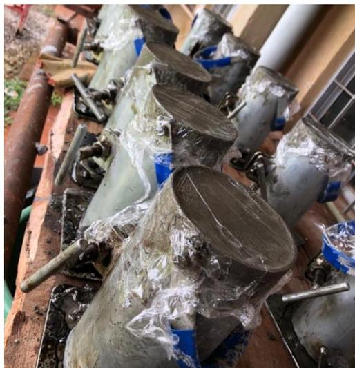
Figura 20 – Corpos de prova após moldagem.
