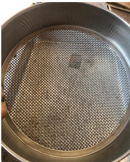
Figura 6 – Peneira com abertura de 2 mm.
