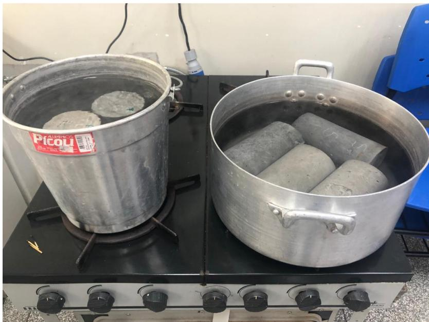
Figura 27 – Corpo de prova em ensaio de fervura por 5 horas.
