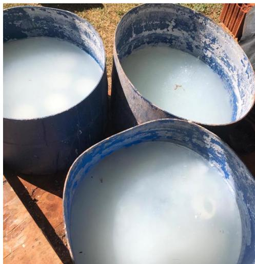
Figura 22 – Corpos de prova curando em solução saturada com cal.
