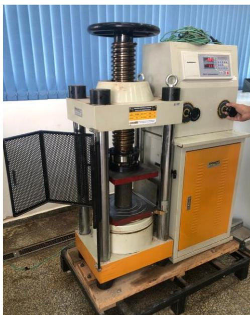
Figura 25 – Ensaio a compressão do corpo de prova na prensa hidráulica.
