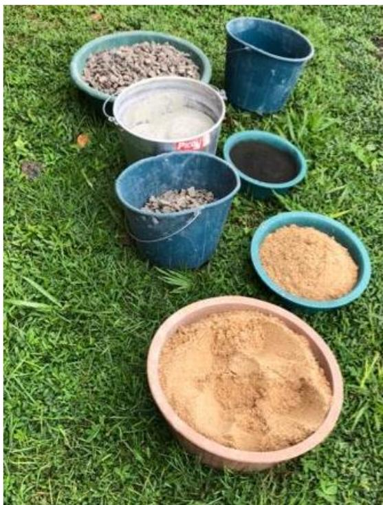
Figura 17 – Materiais separados para confecção do concreto.
