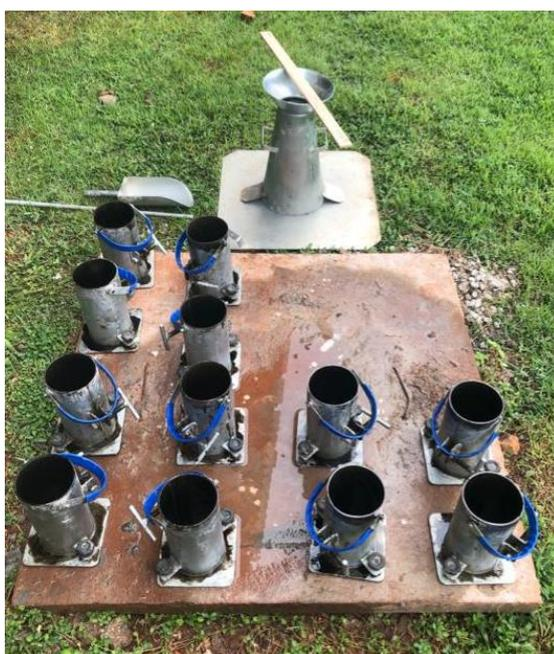
Figura 19 – Equipamentos para realização do slum test e formas cilíndricas para moldagem dos corpos de prova.
