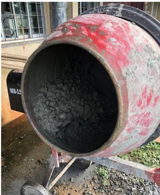
Figura 18 – Materiais sendo misturados na betoneira.
