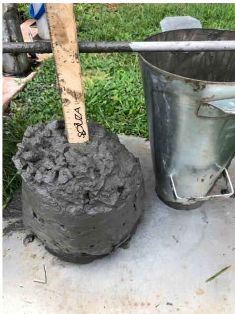
Figura 23 – Ensaio de slump test sendo realizado.
