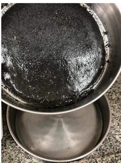
Figura 11 – Cinza do bagaço da cana de açúcar sendo ensaiada conforme NBR NM 46/2003.
