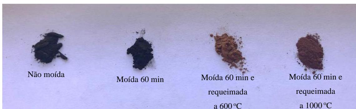
Figura 15 – Amostras analisadas via MEV, EDS e DRX da cinzas do bagaço da cana-de-açúcar.
