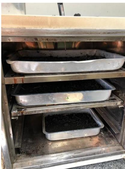
Figura 5 – Cinza do bagaço da cana-de-açúcar na estufa.
