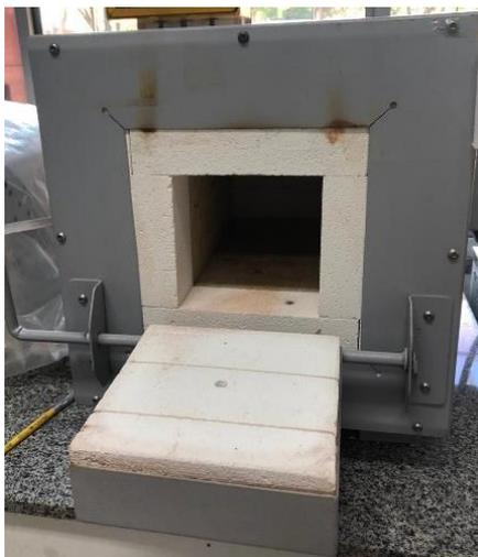
Figura 13 – Mufla utilizada no ensaio de 600 °C.
